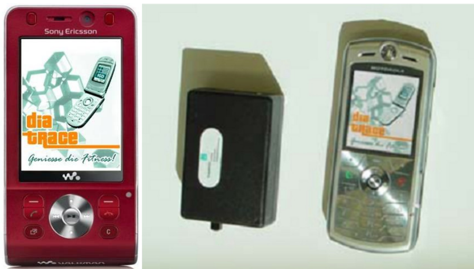
Abbildung 1. Teletechnologie zur Erfassung von körperlicher Bewegung: Motion Sensor Board (MoSeBo) (in der Mitte) und Fotohandy mit integriertem Bewegungssensor (DiaTrace) (links und rechts).
